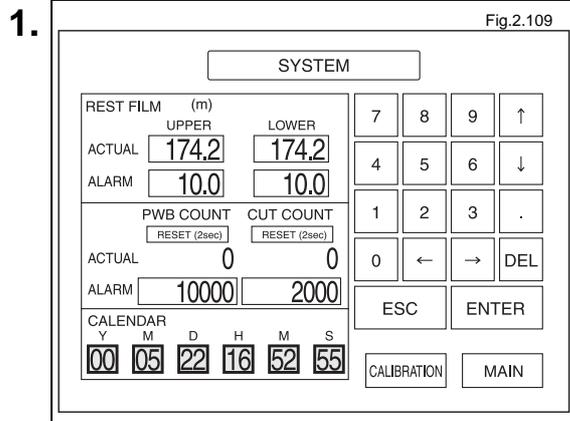
Press the square frame for the "Y", "M", "D", "H", "M", or "S".
